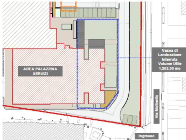
L'elaborazione numerica descritta nella specifica relazione di compatibilità idraulica ha stimato un volume di invaso necessario a laminare la piena e a garantire la stabilizzazione idraulica. I parametri principali utilizzati nel dimensionamento sono il Tempo di ritorno pari a 50 anni e portata concessa allo scarico 10 l/(s·ha).
